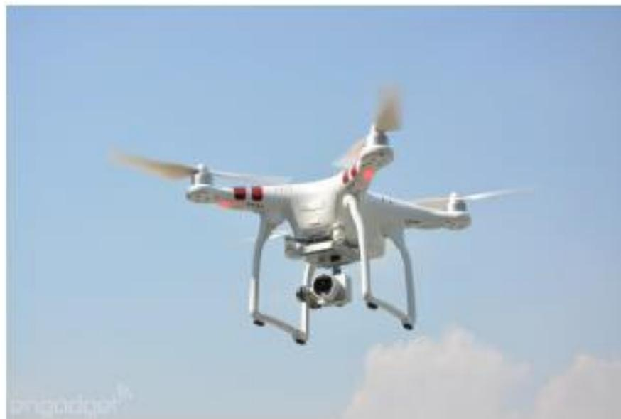
4螺旋槳不同轉速，可以穩定飛行並前後左右移動或旋轉。
