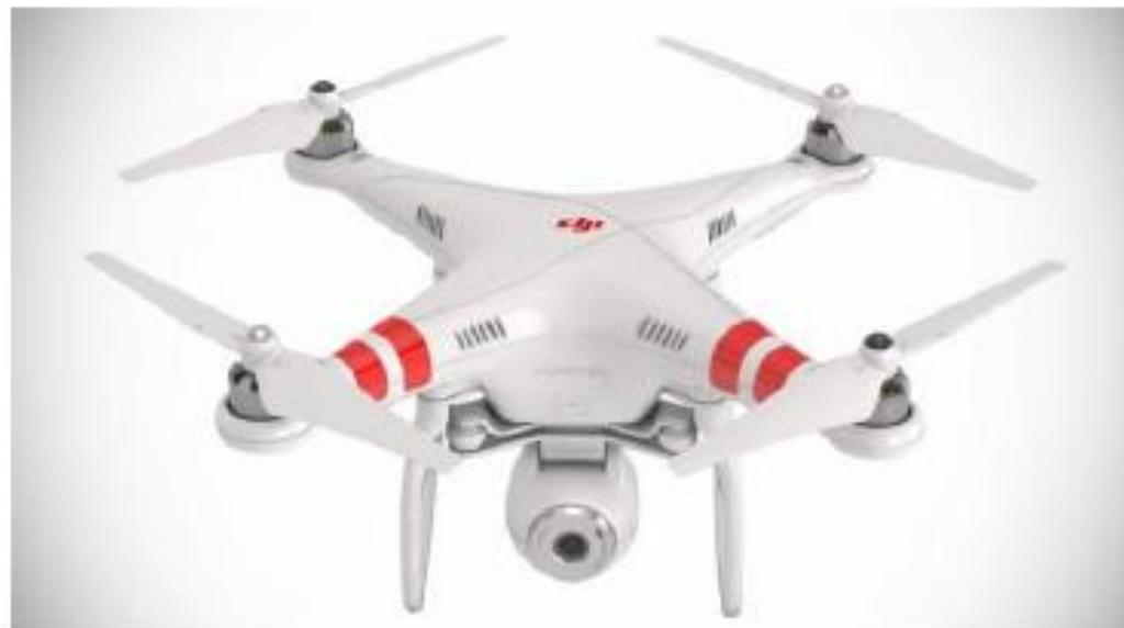
4螺旋槳互相抵消彼此產生的反向扭力，穩定飛行。
