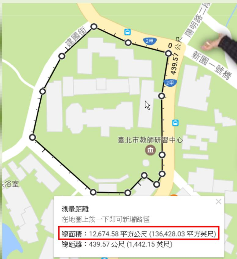
\*步驟 10：當所有的節點圍繞成封閉的狀況，會另外顯示總面積。
